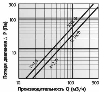
Аэродинамические характеристики круглых решеток РКФ
